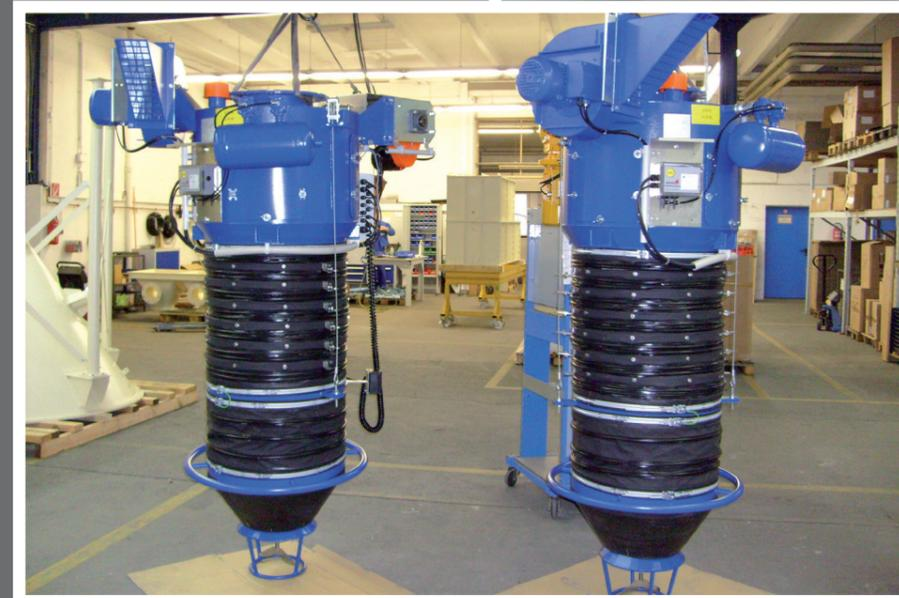
**ANWENDUNGSBEREICH** Mit Verladeschläuchen werden kleinstückige, körnige und pulvrige, heiße und abrasive Güter ausgetragen, verladen oder gefördert. Hauptanwender sind Zementfabriken, chemische Werke, Mühlenbetriebe, Mälzereien, Kraffutterhersteller, Salz- und Kohlebergwerke, Kohlekraftwerke und Unternehmen der Nahrungsmittelindustrie.
